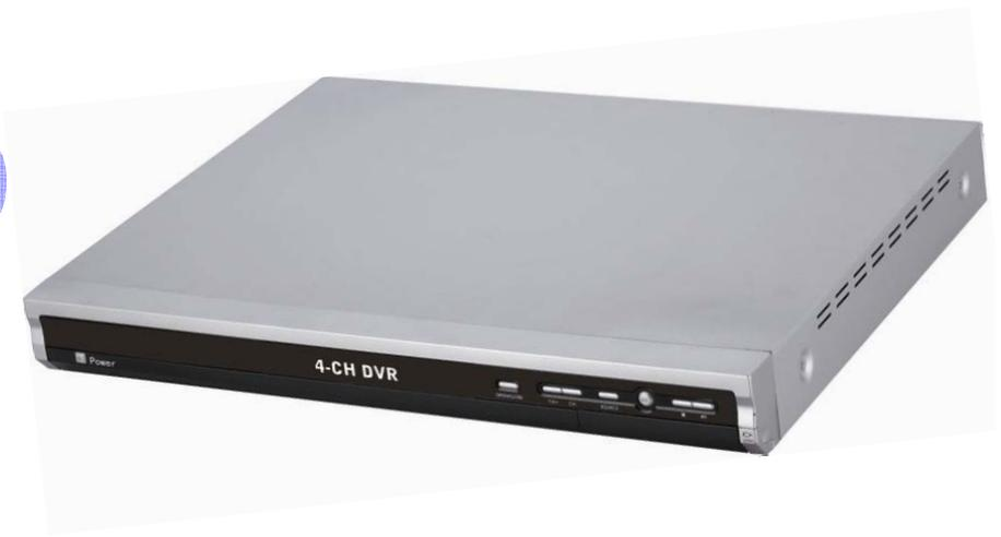
一般防盜DVR，分為pc base 和 stand-alone，如pc base 的DVR，多數分1、4、8、16路鏡頭，至於貯存量多少，是加多少HDD而定，一般以4U 機箱的DVR，可以安裝4-6HDD，以300GB為例，就可以1.2T - 1.8T，如需要加大，多數都會以電腦產品RAID CARD去做，如加RAID CARD 去做可以迎合你的要求，但先了解你的要求，因DVR看的畫面秒幅，是主要決定畫質/貯存/傳送的關鍵，一般DVR用的壓縮技術MPEG4大約每秒幅SIZE為3-7KB，而H.264 (1.5-5KB)，而MPEG4在實時情況下(每秒走動25幅/PAL)，2T可以大約錄200日(會因鏡頭畫面情況而定)，至於穩定性，stand-alone DVR的穩定性 會比PC BASE的強，而比較常出問題的HDD，亦有一種專門比DVR用的HDD，價錢也差不多，可以試試].....
